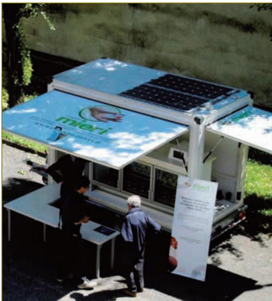
zione fieristica, ecc.) l'energia per il funzionamento del banco refrigerato viene dispensata in massima parte dalle piastre eutettiche che cedono gradualmente frigoriferie e parzialmente anche da un sistema fotovoltaico, che
