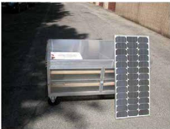
**Foto 15. Essiccatore solare orizzontale con sistema fotovoltaico**
