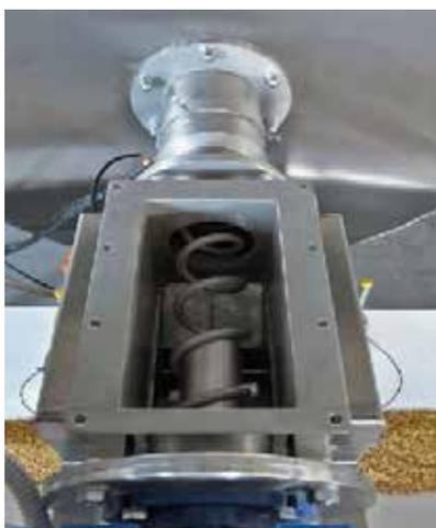
**Foto 5. Trasporto elicoidale** - Le difficoltà riscontrate con il nastro trasportatore sono state superate con il ricorso ad un trasporto con elicoidale. In questo modo si garantisce sia il rimescolamento del prodotto durante il trasporto sia il confinamento degli insetti adulti ad un volume che raggiunge la temperatura letale, garantendo la totale disinfezione.
