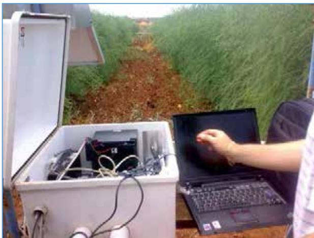
Foto 6. Una nuova figura professionale: il programmatore di data-logger che acquisisce dati micro-meteorologici ed attua l'irrigazione.
