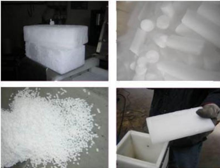
**Foto 5.** Ghiaccio secco ottenuto dalla CO<sub>2</sub> pressurizzata e spinta attraverso stampi che possono avere diverse forme. Nel sistema automatizzato di pulitura si utilizzano piccoli pellets di ghiaccio secco.
