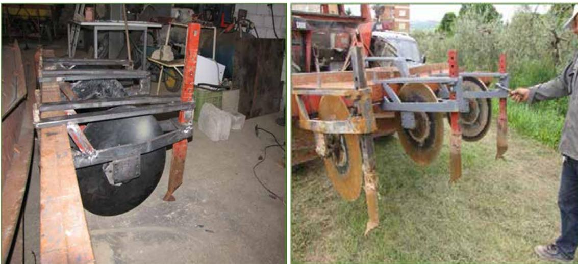
*La nuova versione permette il perfetto allineamento di disco e coltello e una eccellente discissura del terreno fino anche a 35 cm di profondità senza alcun effetto di trascinamento delle colture di copertura, siano esse graminacee che leguminose o crucifere.*
