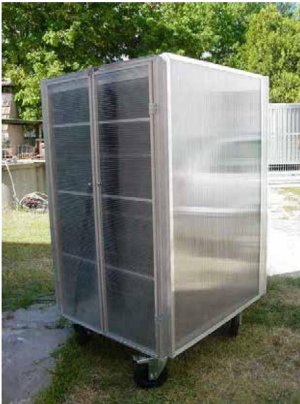
**Foto 13. Essiccatore solare verticale ad armadio con ventilazione**
