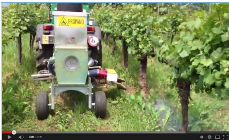
Applicazione di calore istantaneo per l'esecuzione del pirodiserbo e la spollonatura in vigneto ad alta densità. Tale vigneto è posto in zona collinare e quindi la macchina dotata di carrello con ruote e viene applicata sul sollevatore posteriore della trattrice. Questa soluzione facilita molto l'operatività della macchina che può raggiungere una velocità di lavoro di 5-6 km/ora.
