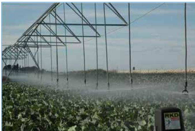
**Foto 1. Impianto di irrigazione a pivot.**
