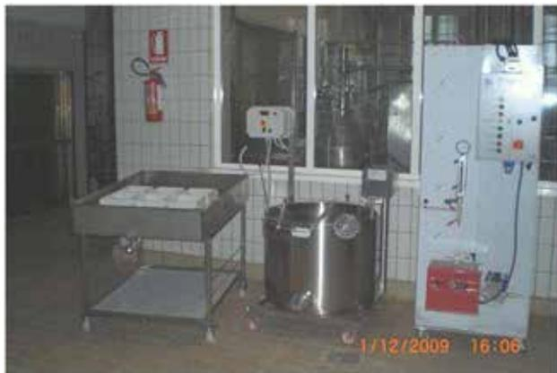
**Foto 1. Impianto di Minicaseificio - Prototipo miniaturizzato di Minicaseificio su ruote**
