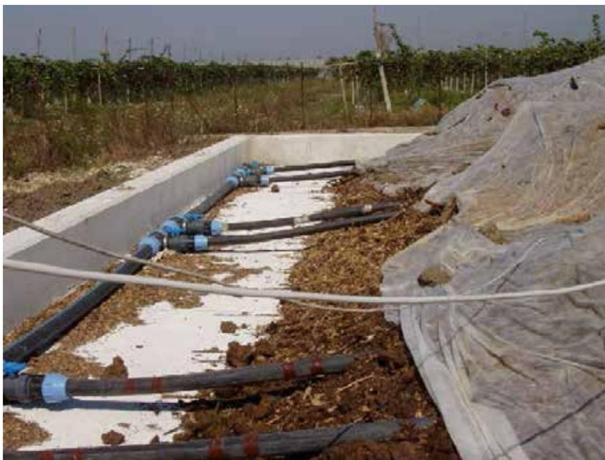
*Impianto di compostaggio on farm di biomasse agricole in esercizio con il cumulo costruito mediante miscelazione delle biomasse e opportunamente ricoperto con tessuto-non-tessuto.*
