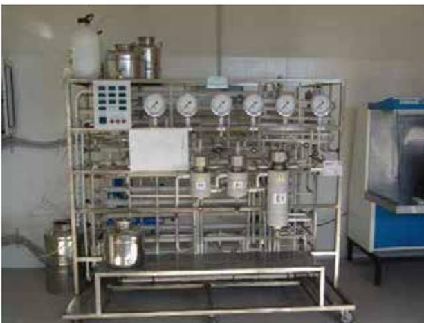
Foto 1. Impianto di pastorizzazione a freddo del succo operante con anidride carbonica supercritica
