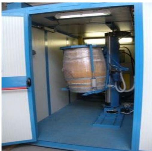
*Sistema automatizzato per il trattamento delle barrique con sabbatura con ghiaccio secco*
