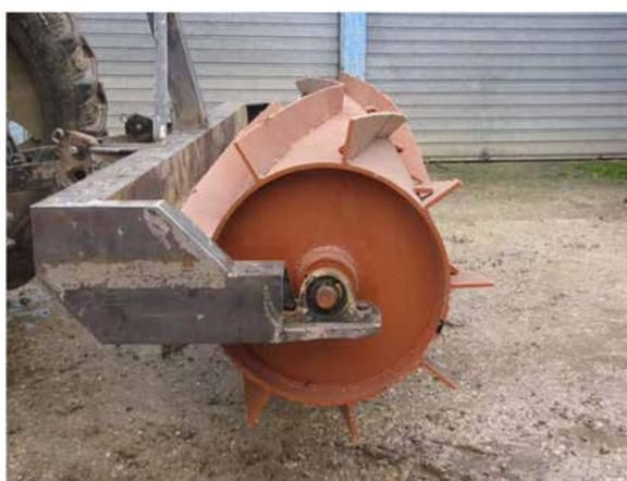
Per consentire il trapianto delle colture orticole nel 2011 è stato costruito un **PRIMO PROTOTIPO DI DISCISSORE** basato su un disco montato davanti al coltello, entrambi posizionati subito dopo il roller crimper.
