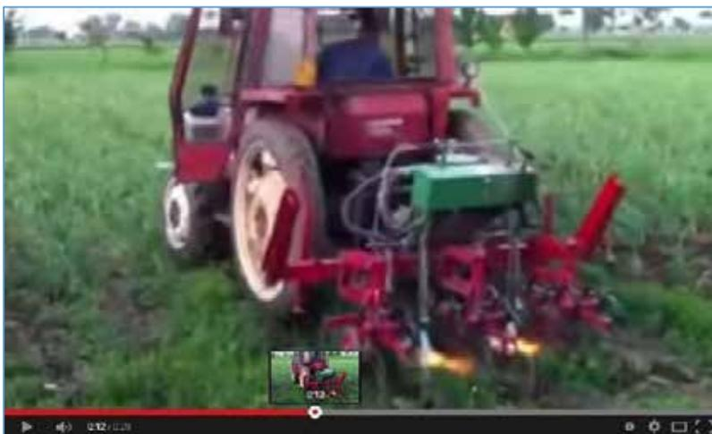
Applicazione del calore istantaneo mediante attrezzatura da pirodiserbo montata su sarchiatore a file. L'operazione si può eseguire a post-trapianto quando l'altezza del prodotto è almeno 20 cm (la pianta ha 4 foglie vere). Il trattamento di pirodiserbo viene effettuato sulla fila dell'aglio per una larghezza di cm 15. Il prodotto non subisce alcun danno poiché è protetto nella sua parte alta (apice centrale) da un getto d'aria.
