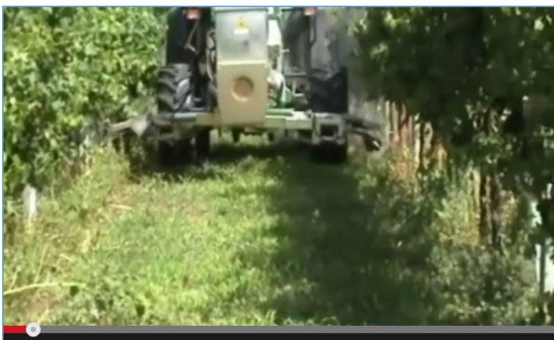
Applicazione di calore istantaneo con macchina dotata di doppio braccio di lavoro. La macchina è montata anteriormente alla trattrice e consente una miglior visibilità di lavoro permettendo una maggiore velocità di esecuzione del trattamento. Un braccio, lato destro di marcia, è gestito tramite comandi manuali dall'operatore; l'altro braccio è posizionato in maniera automatica da un sensore che lo dispone automaticamente ad una distanza corretta dalla fila, circa 30 cm.
