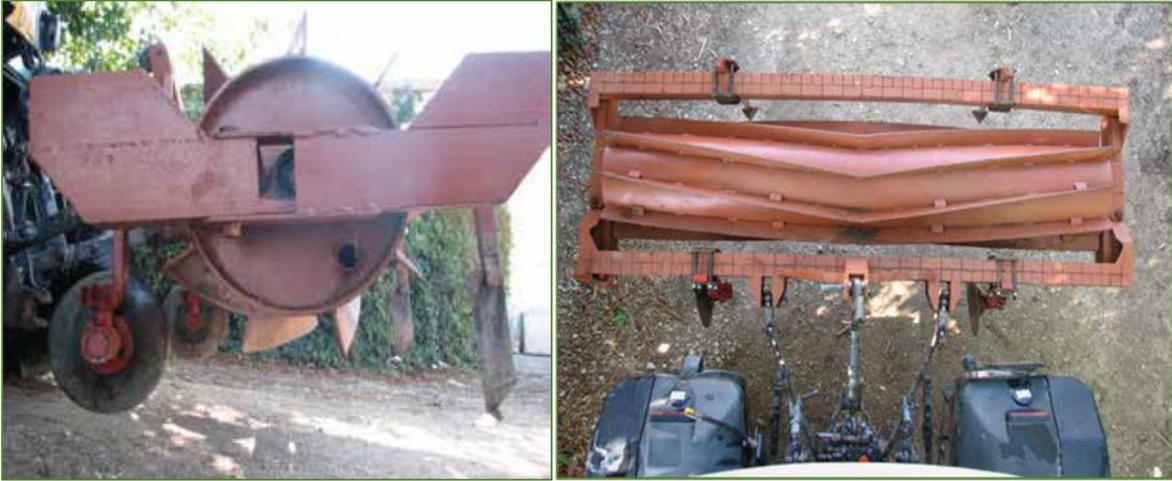
*L'azione del discissore di nuova concezione è risultata buona ma di difficile applicabilità per la difficoltà di allineare disco e coltello. In mancanza di questa condizione l'azione del discissore provoca il trascinamento delle piante e la scopertura del terreno.*
