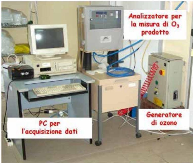
**Foto 2. Impianto sperimentale di ozonizzazione** - Sistema di dosaggio e monitoraggio dell'ozono negli ambienti di frigoconservazione.
