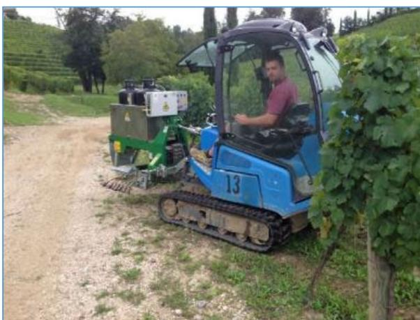
**Foto 5. Pirodiserbo in vigneto su macchina semovente cingolata**
