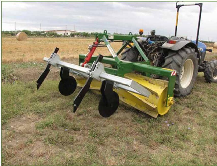
*Questa ultima versione permette il perfetto allineamento di disco e coltello e una eccellente discissura del terreno senza alcun effetto di trascinamento delle colture di copertura; il dispositivo idraulico consente di non smontare i discissori durante il primo passaggio dell'ILRC per allettare le piante.*
