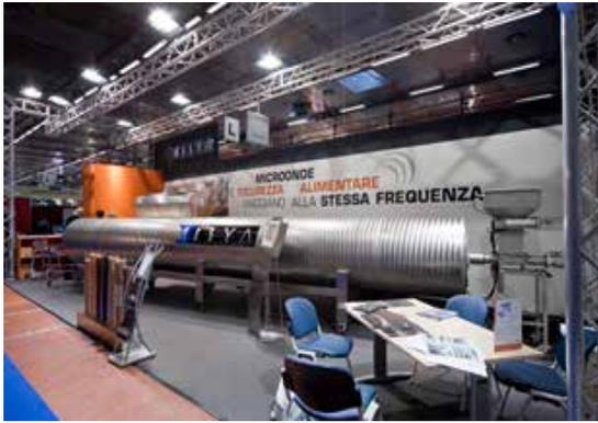
**Foto 7. Impianto MISYA -** La disinfestazione a microonde avviene attraverso il trattamento termico della derrata attraverso le microonde, in un ambiente schermato, ovvero tutta l'energia viene concentrata sul prodotto senza contaminare l'ambiente circostante risultando sicura anche per gli operatori. Il personale dedicato alla disinfestazione si limita a controllare il processo attraverso un touch screen posto in prossimità dell'impianto.
