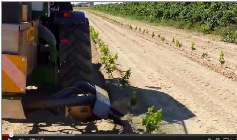
Applicazione di calore istantaneo per l'esecuzione del pirodiserbo in un impianto di barbatelle. La presenza del getto d'aria è fondamentale nell'eseguire questa tipologia d'intervento poiché impedisce la risalita di calore sulle foglie delle giovani piante (le foglie basse si trovano ad una altezza da terra di cm 20 circa). Contemporaneamente all'operazione di diserbo si esegue anche una lotta contro le malattie fungine, riducendo l'inoculo presente sui residui culturali.
